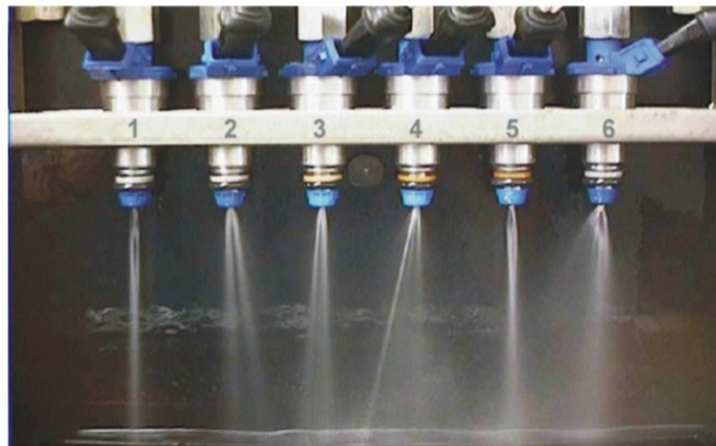
Rampe de contrôle d'injecteurs électroniques
